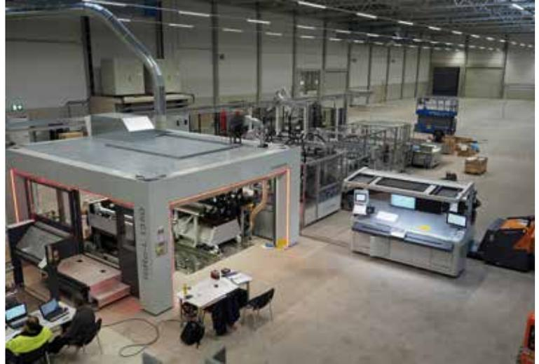
Die Faltschachtel-Produktionslinie besteht aus (v.l.) einem Monomatic Rollenwechsler, Einzugswerk, fünf-Manroland-Goss-Offset-Druckwerken, einem Flexo-Lackierwerk, dem „Quality Module“, einer Madern-Rotationsstanze (rechtes Bild; sie wird aufgrund der hohen Lärmentwicklung gekapselt) sowie einer CSI-Packaging-Postpress-Einheit, wo die Stanzlinge gestapelt, gewendet und palettiert werden.
